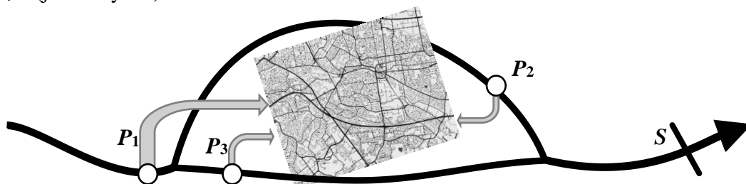
Rys.1 Trzy ujęcia wody dla aglomeracji miejsko-przemysłowej znajdujące się na tym samym cieku, przekrój wodowskazowy
