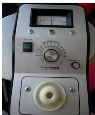
Rys.2. Zestaw do pomiaru stałej dielektrycznej Lubri Sensor [20]
